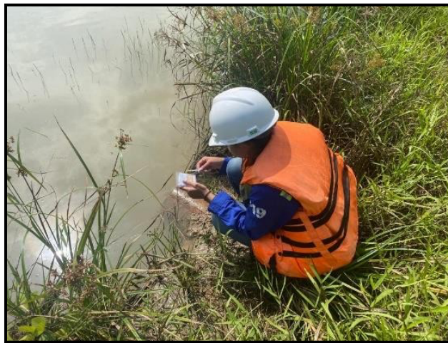
Gambar 1. Mengukur pH Air Limbah Tambang
